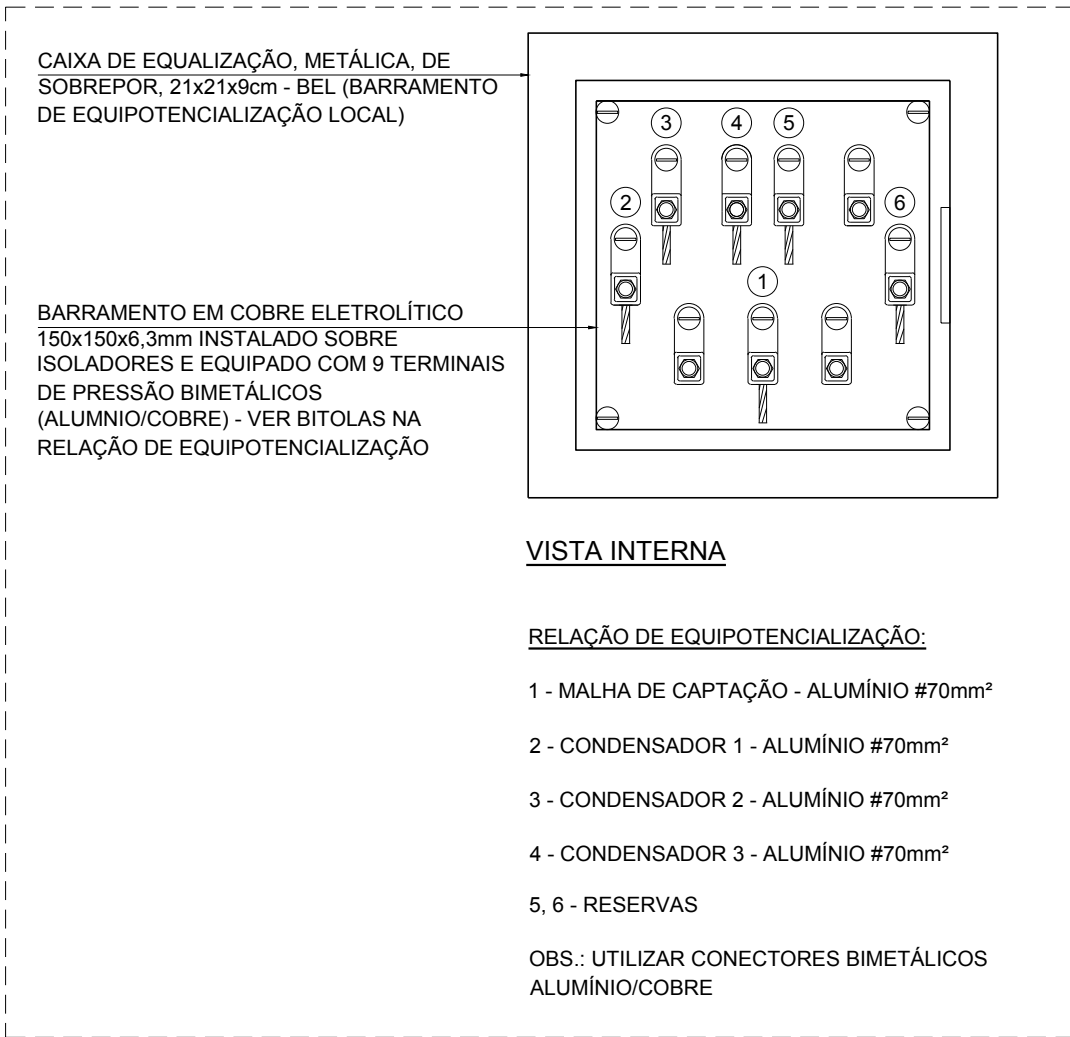
DET. BEL-2 - BARRAMENTO DE EQUIPOTENCIALIZAÇÃO LOCAL INSTALADO NA PLATIBANDA DA LAJE TÉCNICA - h=40cm SEM ESCALA
